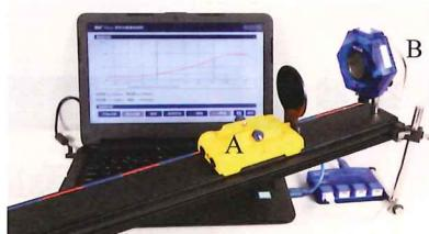
图1.4-3 利用传感器测量物体运动的速度
