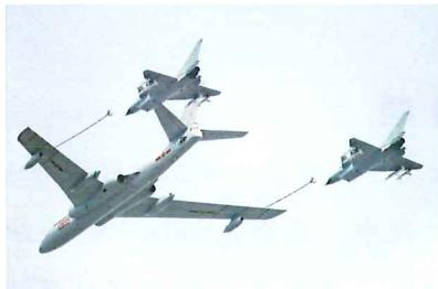
乙 加油机对受油机进行空中加油
