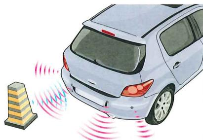
图2.3-4 利用超声波定位的倒车雷达
